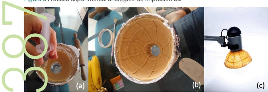
(a) Proceso de vertimiento del material sobre un preforma con ayuda de una jeringa. (b) Estructura interna. (c) Resultado final y aplicación.
